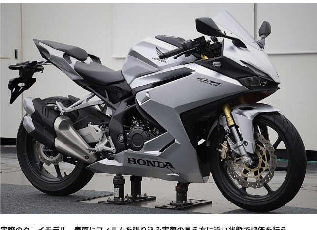
実際のクレイモデル 表面にフィルムを張り込み実際の見え方に近い状態で評価を行う
